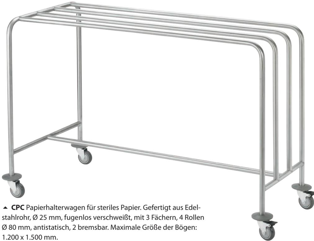
▲ **CPC** Papierhalterwagen für steriles Papier. Gefertigt aus Edelstahlrohr, Ø 25 mm, fugenlos verschweißt, mit 3 Fächern, 4 Rollen Ø 80 mm, antistatisch, 2 bremsbar. Maximale Größe der Bögen: 1.200 x 1.500 mm.
