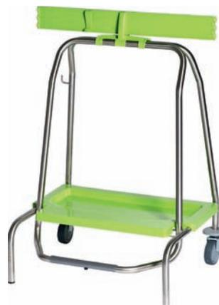
Klemm-Mechanismus und Bodenplatte bestehen aus bambusgrünem Polypropylen und sind im Spritzgussverfahren hergestellt. Der fugenlose Klemm-Mechanismus ohne scharfe Kanten verfügt über zwei Laschen zur Befestigung des Abfallsacks. Er ist abziehbar und bei 121°C 20 Minuten lang **autoklavierbar**.
